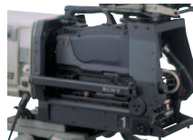
CA-905K/905F/905L 大型演播室镜头适配器和 7 英 寸寻像器座(照片显示的是 CA-905L/BKP-9057 同 Sony 摄像机安装在一起)
